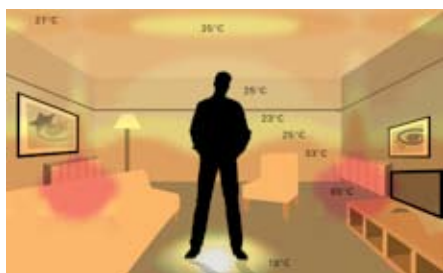
Patalpos temperatūra, kai nenaudojama grindų šildymo sistema. Kambaryje jaučiami dideli temperatūros skirtumai (18 - 65°C).
