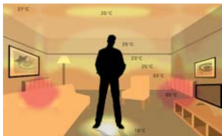
Распределение тепла в комнате при использовании радиаторов. Значительный разброс температур в помещении (18 - 65°C).
